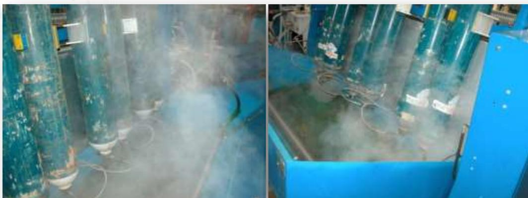
**DRY-VAP** è un innovativo metodo di asciugatura a vapore surriscaldato delle bombole sottoposte a collaudo idraulico.
