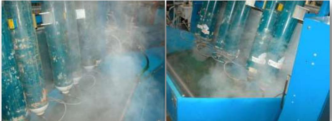
Le **DRY-VAP** est un système très innovant de séchage à vapeur surchauffée indiqué pour les bouteilles essayées hydrauliquement.
