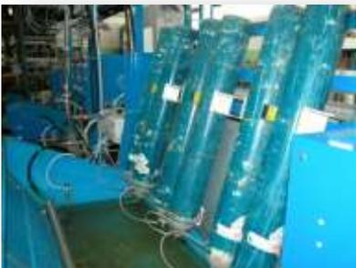
Même si la puissance électrique instantanée du générateur de vapeur excède la puissance du celui à air réchauffée, le bilan de consommation finale énergétique est bien en faveur du séchage à vapeur, avec un épargne d'énergie électrique total consommée.
