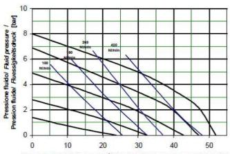
Portata fluido/Fluid flow rate/Débit max. fluide/Foerdermenge der Fluessigkeit [l/min]
