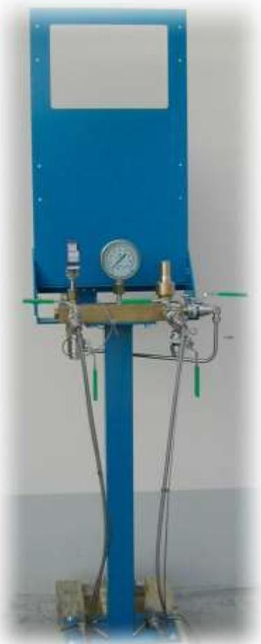
L'unità FCD22 consente il riempimento, tramite controllo manuale, di bombole ed estintori con CO<sub>2</sub> proveniente da serbatoio criogenico. L'operatore agisce manualmente sulle valvole di intercettazione basandosi sulle informazioni fornite dai visualizzatori delle bilance di controllo.
