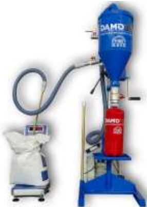
RIEMPLISSAGE D'EXTINCTEUR PORTABLE
