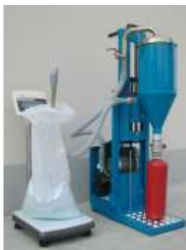
REPLISSAGE D'EXTINCTEUR PORTABLE AVEC BALANCE ETW100
