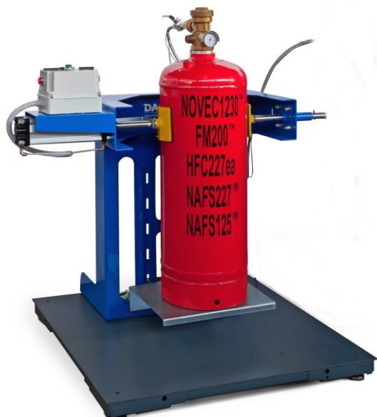
Modello AIR4/BILS installato su bilancia BE nella stazione di Clean Agent
